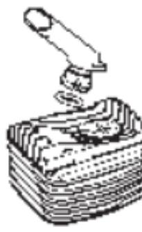
Mundstück mit einer leichten Drehung gegen den Uhzeigersinn aus Kühleinheitdeckel herausziehen. Mundstückdichtring mit Hilfe des Füllkammerwerkzeugs abziehen.
