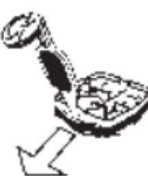
Großen Bodendichtring mit Füllkammerwerkzeug an der Aussparung in der Nut aushebeln.
