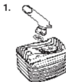
1. Extraer la Boquilla de la Tapa de la Unidad de Enfriamiento girándola ligeramente en sentido contrario a las agujas del reloj. Extraer el Anillo de Sellado de la Boquilla con la ayuda de la Herramienta del Depósito.
