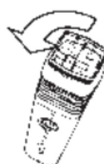
Desenrosque la Unidad de Enfriamiento del Vaporizador girando 90° en sentido contrario a las agujas del reloj.
