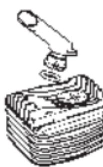
Estrarre il Boccaglio dal coperchio dell'Unità di Raffreddamento ruotandolo leggermente in senso antiorario. Staccare l'Anello di Tenuta del Boccaglio usando l'Utensile del Contenitore.
