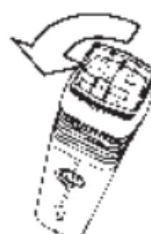
Démonter le fond de l'Unité de Refroidissement du Vaporisateur en le dévissant de 90° dans le sens inverse des aiguilles d'une montre.
