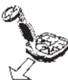
Levante el Anillo de Sellado de Fondo grande con la Herramienta del Depósito en la muesca de la ranura.
