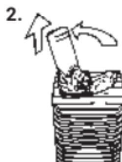
Placer le bord de l'Embout dans l'entaille du Couvercle Rotatif et le faire tourner dans le sens inverse des aiguilles d'une montre pour l'ouvrir et le retirer. Retirer le Joint du Couvercle Rotatif à l'aide de l'Outil de Chambre de Remplissage.
