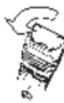
Kühleinheit durch eine 90° Drehung entgegen dem Uhrzeigersinn vom Verdampfer abschrauben.
