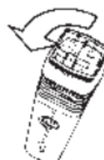
Svitare il fondo dell'Unità di Raffreddamento dal VapORIZZATORE compiendo una rotazione di 90° in senso antiorario.
