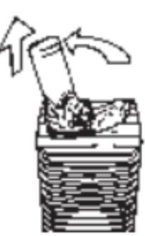
Mettere il bordo del Boccaglio nell'incavatura del Coperchio Girevole e ruotare in senso antiorario per aprire e togliere. Staccare l'Anello di Tenuta del Coperchio Girevole usando l'Utensile del Contenitore.
