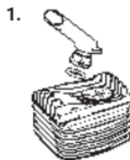
Retirer l'Embout du couvercle de l'Unité de Refroidissement tout en le tournant légèrement dans le sens inverse des aiguilles d'une montre. Retirer le Joint d'Embout à l'aide de l'Outil de Chambre de Remplissage.
