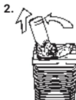
2. Coloque el borde de la Boquilla en la muesca de la Tapa Giratoria, gire en el sentido contrario a las agujas del reloj para abrir y tire. Retire el Anillo de Sellado de la Tapa Giratoria usando la Herramienta del Depósito.
