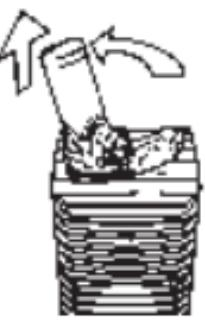
Um den Drehverschluss zu öffnen, den Rand des Mundstücks in die Einkerbung des Drehverschlusses stecken, entgegen dem Uhrzeigersinn drehen und ihn herausziehen. Den Dichtring mit Hilfe des Füllkammerwerkzeugs vom Drehverschluss abziehen.
